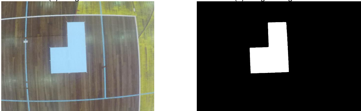
Figura 5 – Processamento da imagem para cálculo da área. (a) Imagem real (b) Imagem segmentada
