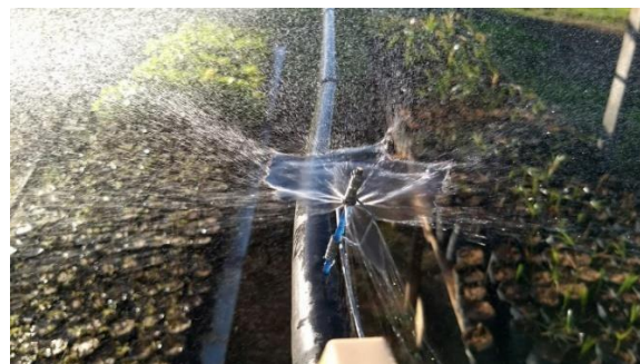
Figura 2. Microaspersor artesanal em funcionamento. Fonte: Acervo pessoal, 2020.
