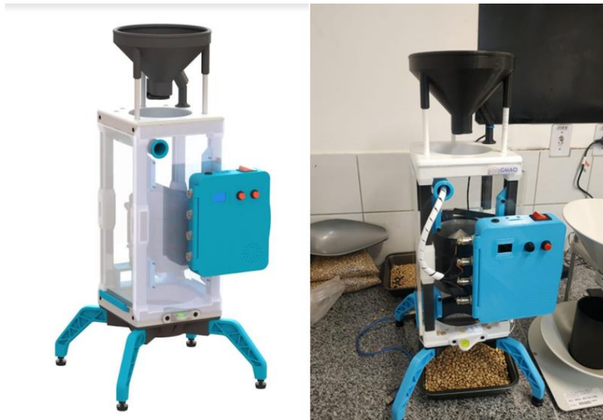
Figura 4. Imagens referente ao equipamento desenvolvido, a esquerda refere-se a modelagem no soldWorks e a direita refere-se ao equipamento confeccionado na impressora 3D logo após feito os testes no laboratório.
