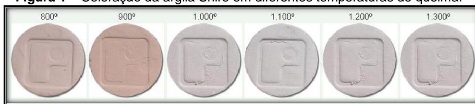
Figura 1 – Coloração da argila Shiro em diferentes temperaturas de queima.
