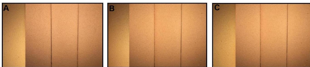
Figura 4 – Fotos dos corpos de prova das formulações estudadas na temperatura de a) 850°C, b) 900°C e c) 950°C, com taxa de aquecimento de 10°C/min, no tempo de 1 hora.
