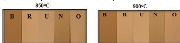
Figura 6 – Fotos dos corpos de prova da massa cerâmica e das formulações estudadas nas temperatura de queima de 850°C e 900°C, com isoterma de 1 hora.
