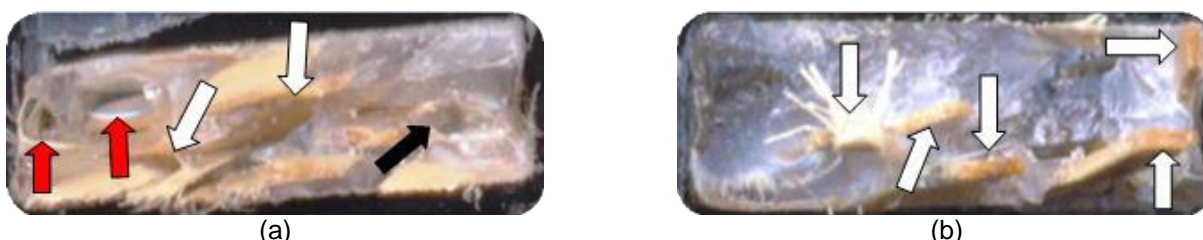
Figura 6 - Região de fratura do compósito de fibra de carnaúba (a) 5 mm e (b) 15mm.
