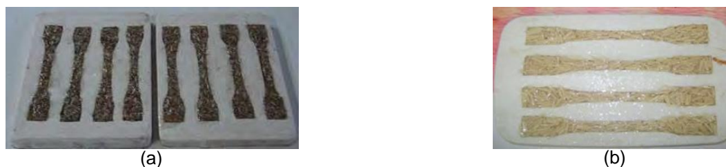
Figura 1 – (a) Corpos de prova dos compósitos reforçados por fibras de sisal (b) palha da costa no molde de silicone.
