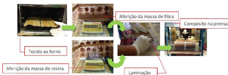
Figura 3 – Fluxograma de produção de compósito reforçado com fibra da folha do ubuçu.
