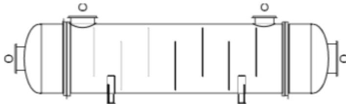
Figura 1: Imagem do trocador de calor gerada pelo exchanger design and rate
