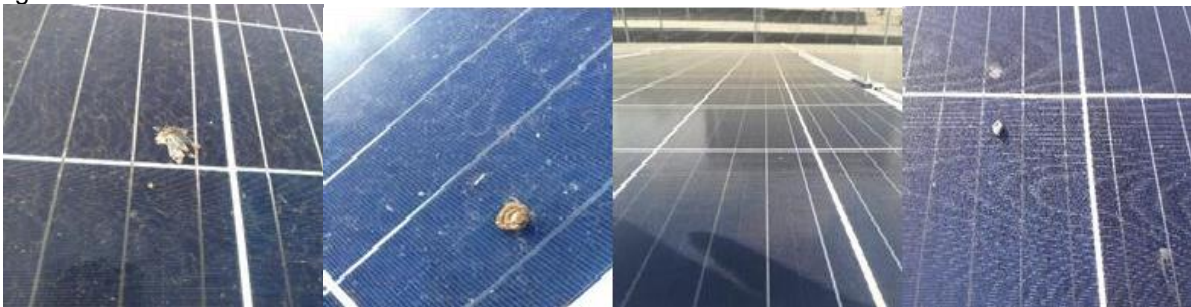
(a) Inseto morto; (b) Excremento de passarinho; (c) Poeiras; (d) Pequenos pedregulhos Fonte: Autor, 2019.
